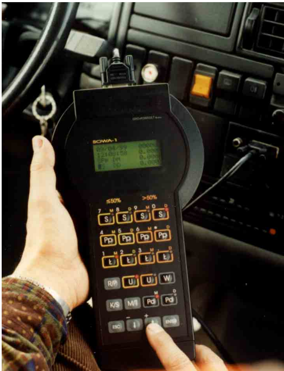
Fot. Przykład urządzenia pomiarowego (Rejestrator SOWA-1 zainstalowany w pojeździe)
